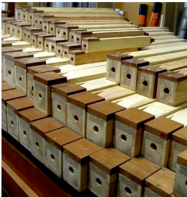
Tubs de fusta en construcció al taller de Joan Bautista Díaz, en Torrent.
