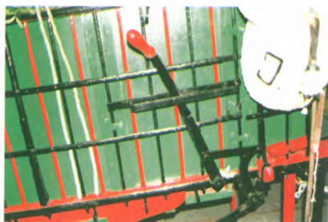
Mecanisme del fre del carro en el varal.
